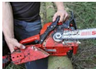
Die innenliegende Kupplung erlaubt einen leichten Kettenwechsel.
